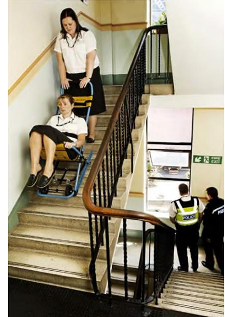
Im Einzelfall können sichere Bereiche in Gebäuden mit **Evakuierungseinrichtungen**, wie z. B. Evakuierungsstühlen, ausgestattet werden (Evakuierung in Fällen der Aufzug nicht genutzt werden kann = „Plan B“ nach DIN CEN/TS 81-76)
