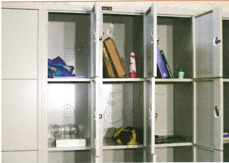
Abb. 2: Einbrennlackierte Schließfächer aus Stahlblech beim Versuchsaufbau
