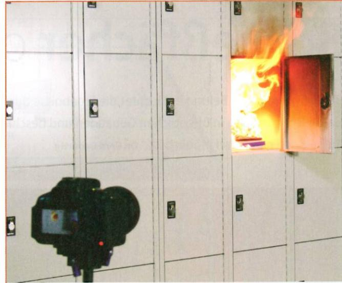
Abb. 3: Das Versuchsfach beim Entzünden der Brandlasten
